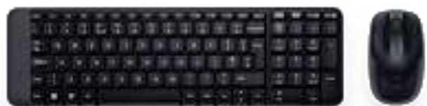
4. **MOUSE** Es un dispositivo o periférico de entrada, utilizado para facilitar el manejo de un entorno gráfico en una computadora. Generalmente está fabricado en plástico, y se utiliza con una de las manos.
