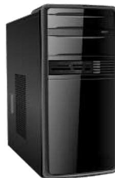
También conocida como la caja, carcasa, chasis, gabinete de computadora, es la estructura metálica o plástica, cuya función consiste en albergar y proteger los componentes internos de la computadora.
