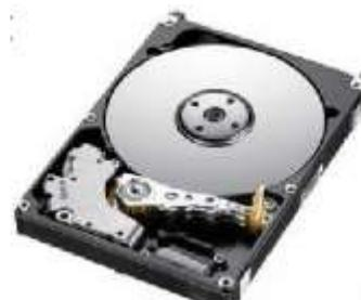
**4. DISCO DURO**, ( hard disk (HD)) disco magnetico en el que puedes almacenar datos del ordnador. El disco dura es la parte del ordenador que contiene informacion electronica y de donde se almacena todos los prgramas (software). Es unos de los componentes del hardware mas inportantes denro del PC.
